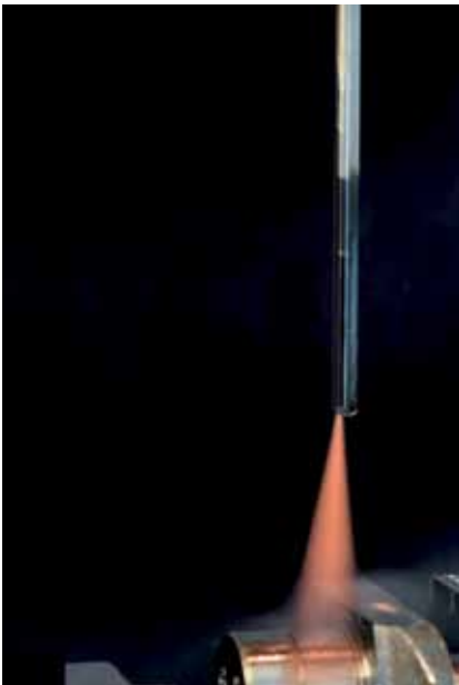
Bild 1: MMS wird heute in der Anwendung so gezielt dosiert, dass für den Zerspanprozess nur wenige Milliliter KSS pro Stunde benötigt werden
