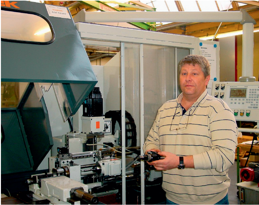
2 Als Erfinder des Axial-Pulsators und Leiter der Abteilung Versuch ist sich Jürgen Deeg sicher: Das Gerät erweitert deutlich die Leistungsgrenzen beim Tieflochbohren mit gerade genuteten Werkzeugen und bewahrt gleichzeitig die Vorteile des Einlippenbohrverfahrens
